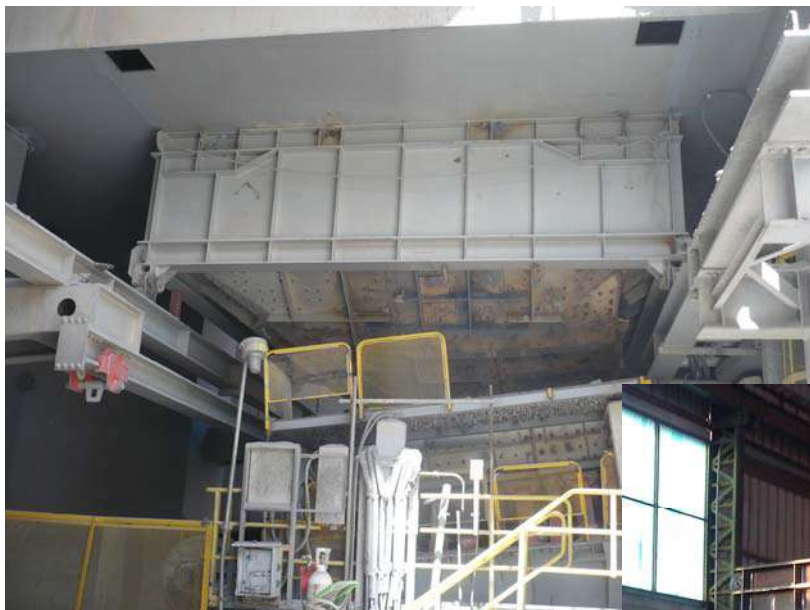
Levantamiento, ingeniería, calculo y fabricación de chute de descarga chancador primario
