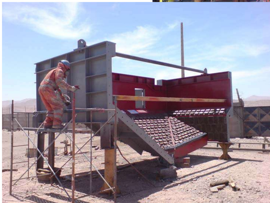
Levantamiento, ingeniería, calculo y fabricación de chute de descarga chancador primario
